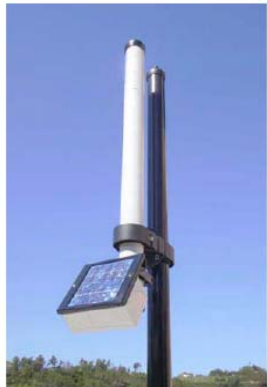
Figura 5 – Centraline PMM 8055 e PMM 8057 utilizzate per il monitoraggio
