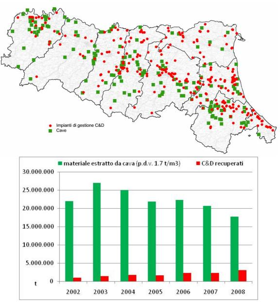
Fig. 3.3 Trend di estrazione degli inerti di cava, relazione con il trend dei rifiuti da C&D avviati a recupero e localizzazione impianti di estrazione e recupero
