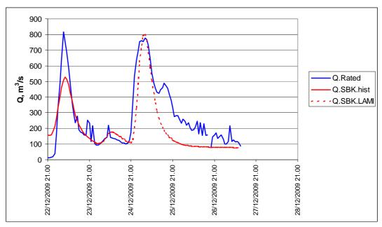
Fig. 5: Confronto tra osservato e previsto di portata nella sezione di Spilamberto sul fiume Panaro. Corsa delle catene previsionali ore 12.00, previsione del colmo di piena con 18 ore di anticipo.
