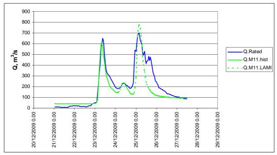
Fig. 6: Confronto tra osservato e previsto di portata nella sezione di RubieraSS9 sul fiume Secchia. Corsa delle catene previsionali ore 12.00, previsione del colmo di piena con 16 ore di anticipo.
