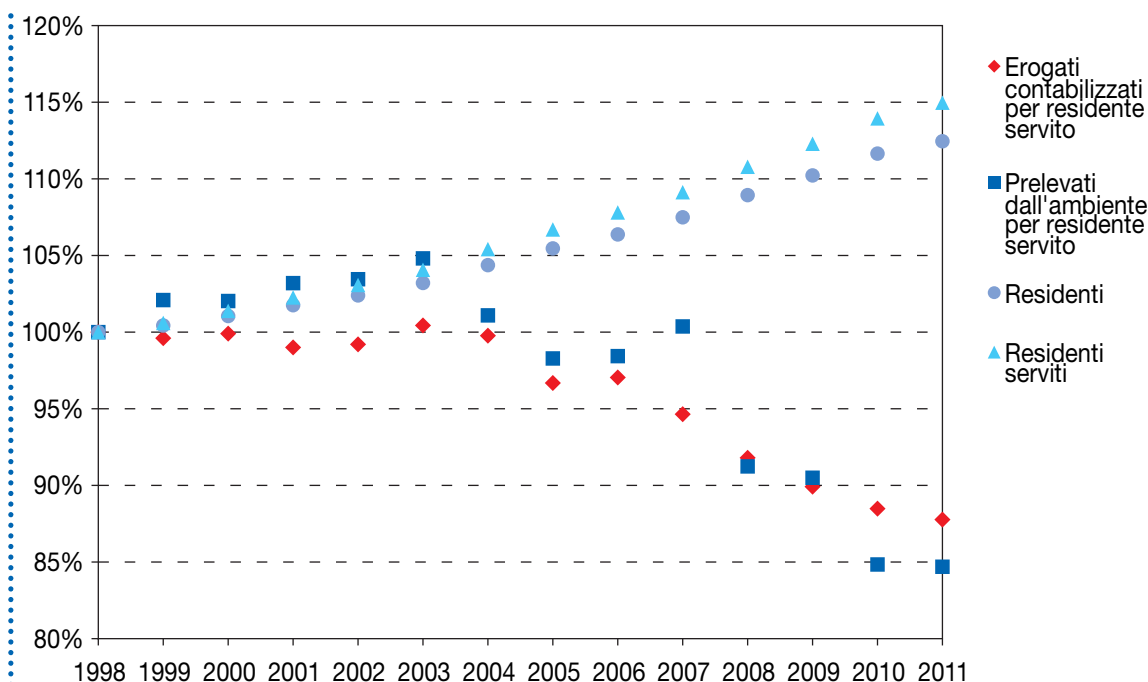
Figura 3A.9: Andamento degli indicatori relativi al settore acquedottistico civile: popolazione residente e servita, volumi prelevati dall'ambiente ed erogati contabilizzati procapite (stime 1998-2011)
