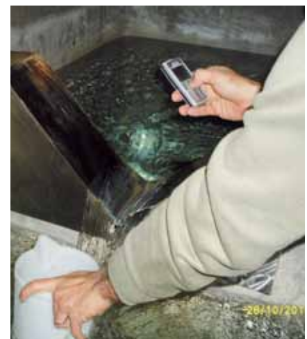
Fig. 2 Misura della portata: da stramazzo con formula e per riempimento di contenitore a volume noto.
