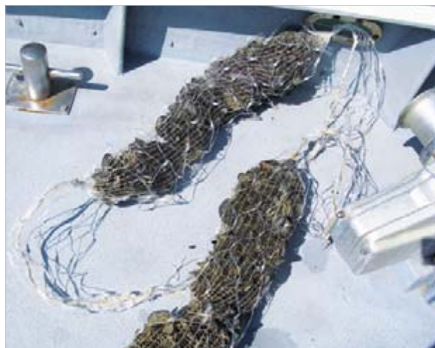
Calze da posizionare in mare in cui sono stati inseriti i mitili per verificare eventuali bioaccumuli.
