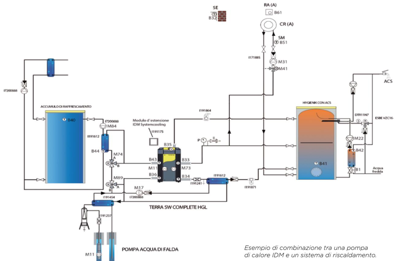
*Esempio di combinazione tra una pompa di calore IDM e un sistema di riscaldamento.*
