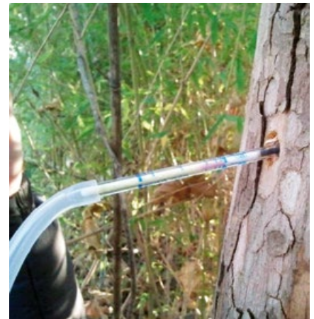
Fiala inserita nel foro precedentemente realizzato per il prelievo di campione di albero. Si può notare il tubo in Teflon che collega la pompa alla fiala. Immagine tratta da "Protocollo operativo per le attività di phytoscreening", Lucina Luchetti e Antonio Diligenti, Arta Abruzzo.
