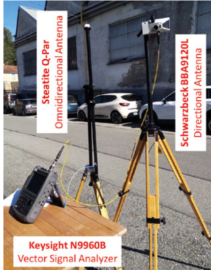
FIG. 3 STRUMENTI Antenne di misura e analizzatore di spettro vettoriale.
