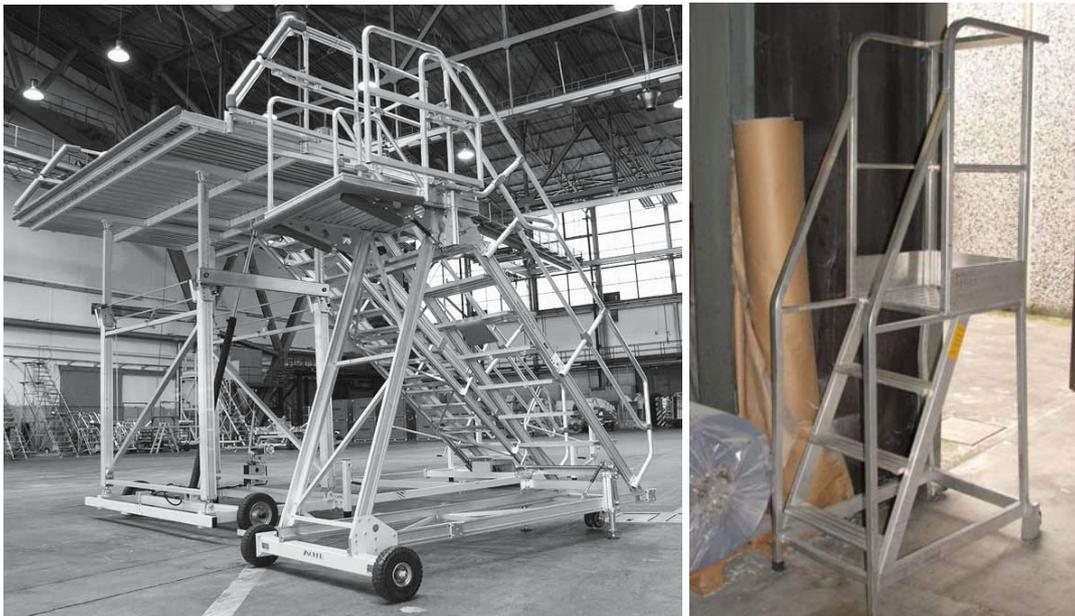
Fig. 23: esempi di ponti a torre su ruote.
