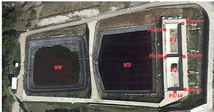
I pozzi spia sono stati realizzati da Herambiente SpA negli anni 2010 e 2013, quali presidi di monitoraggio della tenuta idraulica delle due vasche V1 e V2.
