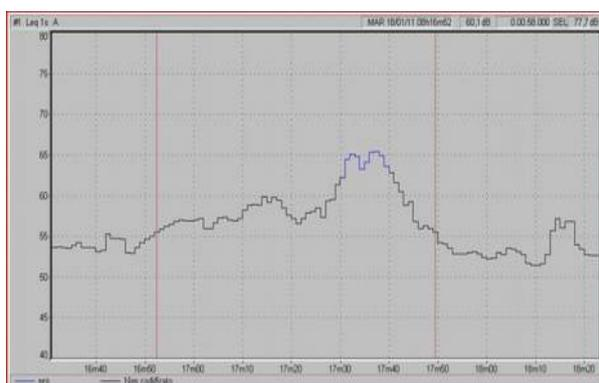
Figura 17: esempio di calcolo del SEL da  $L_{AFmax}$  - 10dB(A)
