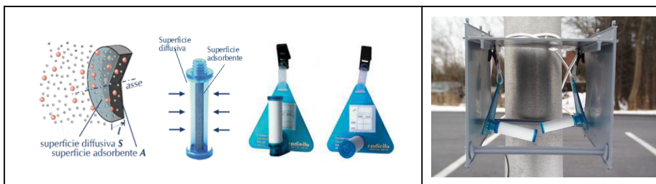
Figura: Campionamento radiale diffusivo (passivo): particolare dei radielli utilizzati per i campionamenti
