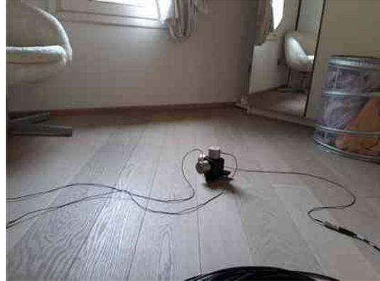
Foto 2: Terna di accelerometri posizionati nel disimpegno su Via Garibaldi
