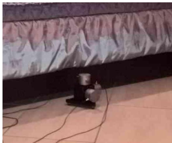
Foto 4: Terna di accelerometri camera da letto
