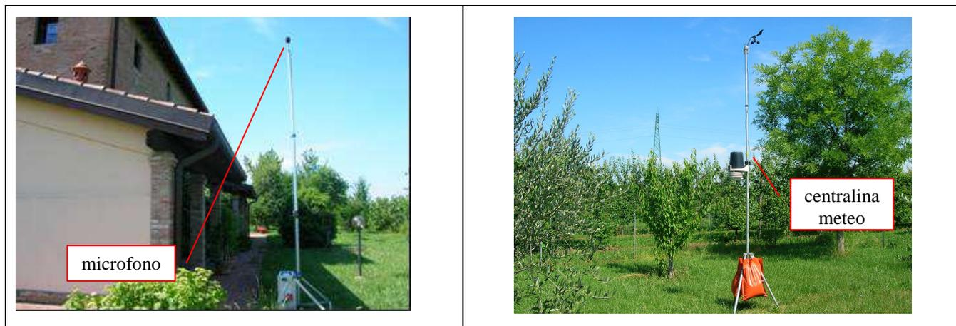
Figura 2 - Strumentazione di misura e sua localizzazione; centralina meteo
