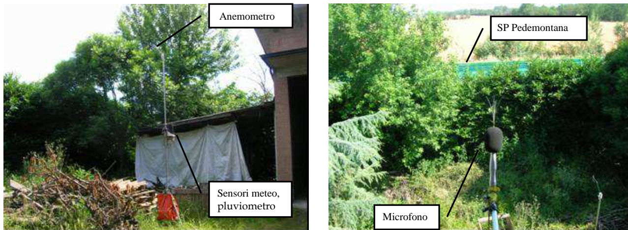
Figura 3 – Centralina meteo e tratto della SP Pedemontana monitorato visto dal punto di misura
