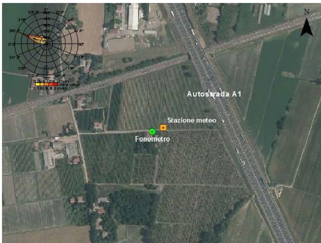
Figura 1 - Area monitorata e localizzazione della strumentazione di misura
