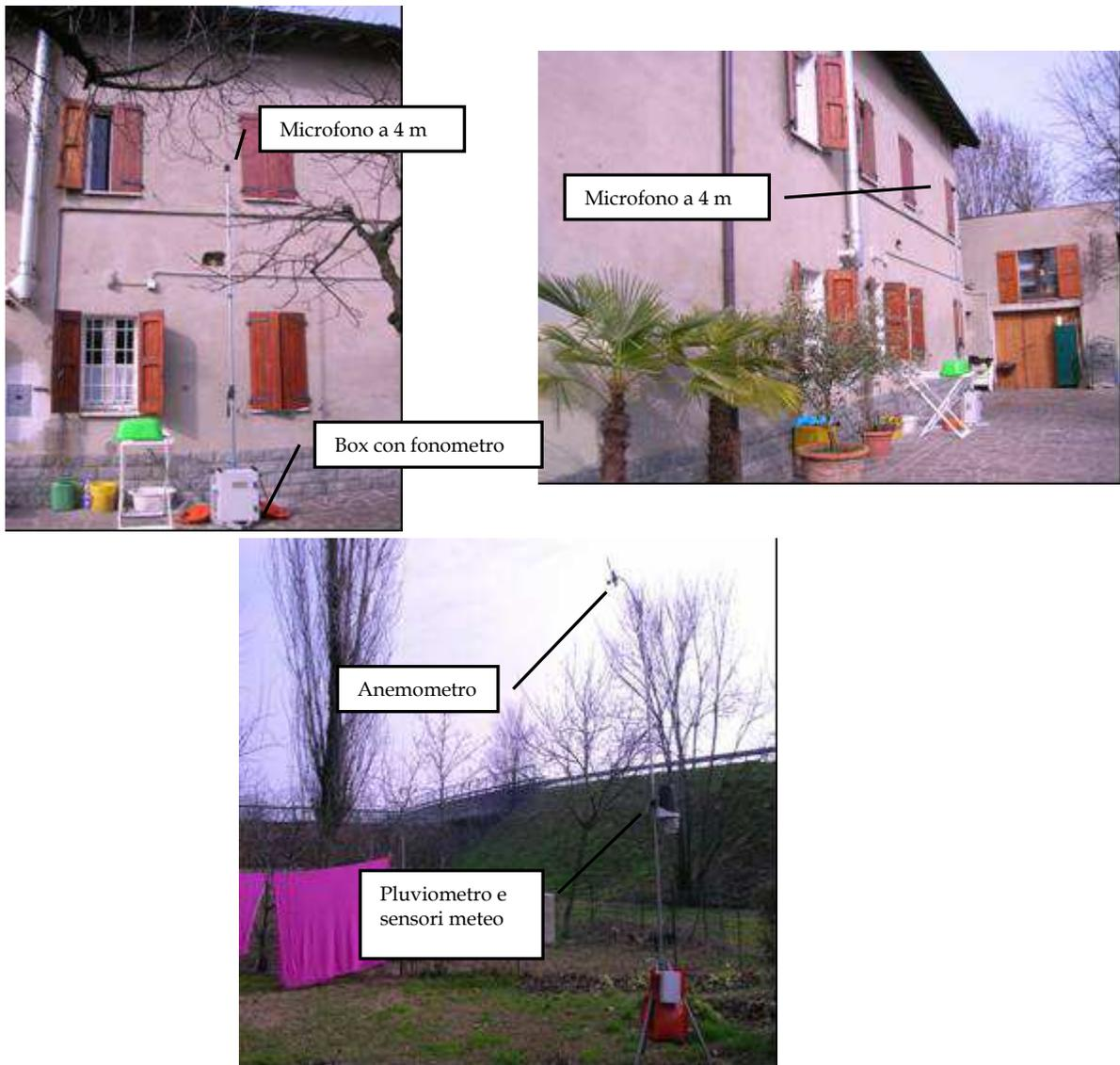
Figura 3 – Strumentazione per il monitoraggio acustico e stazione meteorologica via Omboni 28/1
