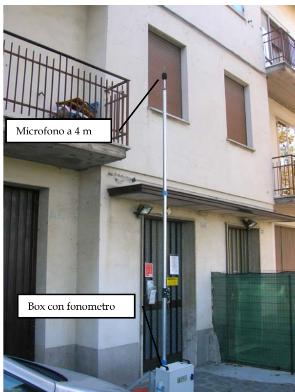
Figura 3 – Strumentazione per il monitoraggio acustico e stazione meteorologica
