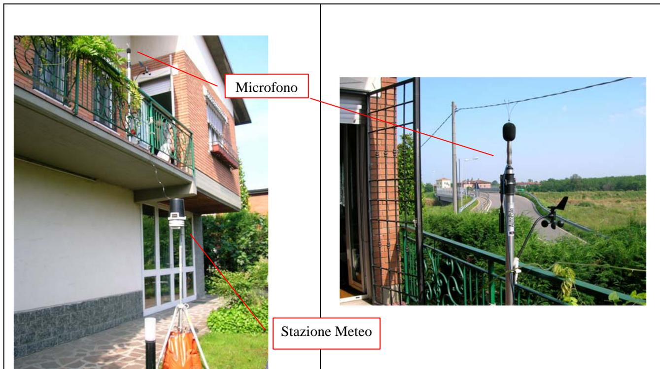
Figura 2 - Strumentazione di misura e sua localizzazione, sul balcone del primo piano dell'edificio
