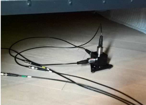
Foto 3: Terna di accelerometri stanza su Via Garibaldi
