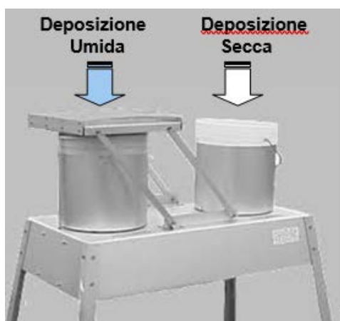
Figura 4.44 – Deposimetro Wet&Dry per la raccolta separata delle deposizioni secche ed umide
