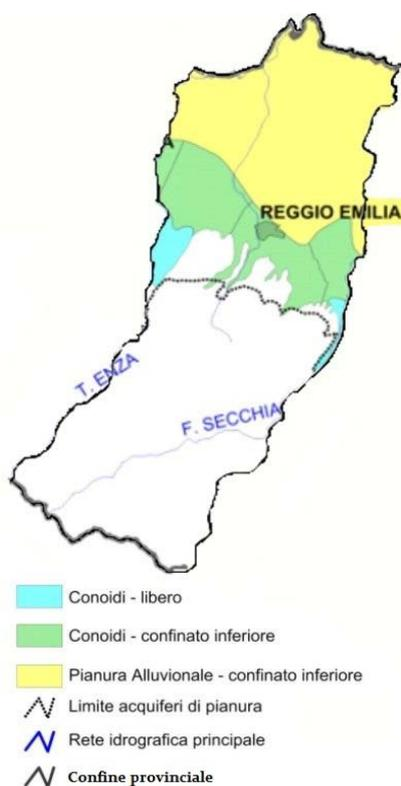
**Figura 3: corpi idrici sotterranei di pianura confinati inferiori (acquiferi A3, A4, B e C).**
