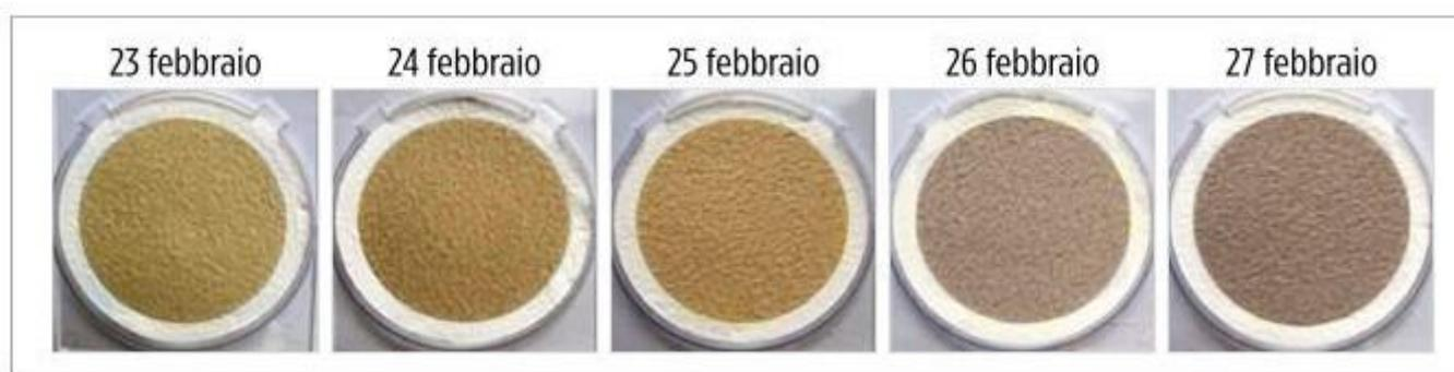
*Figura 13 - Colorazione del materiale particellare raccolto presso la stazione di Febbio*
