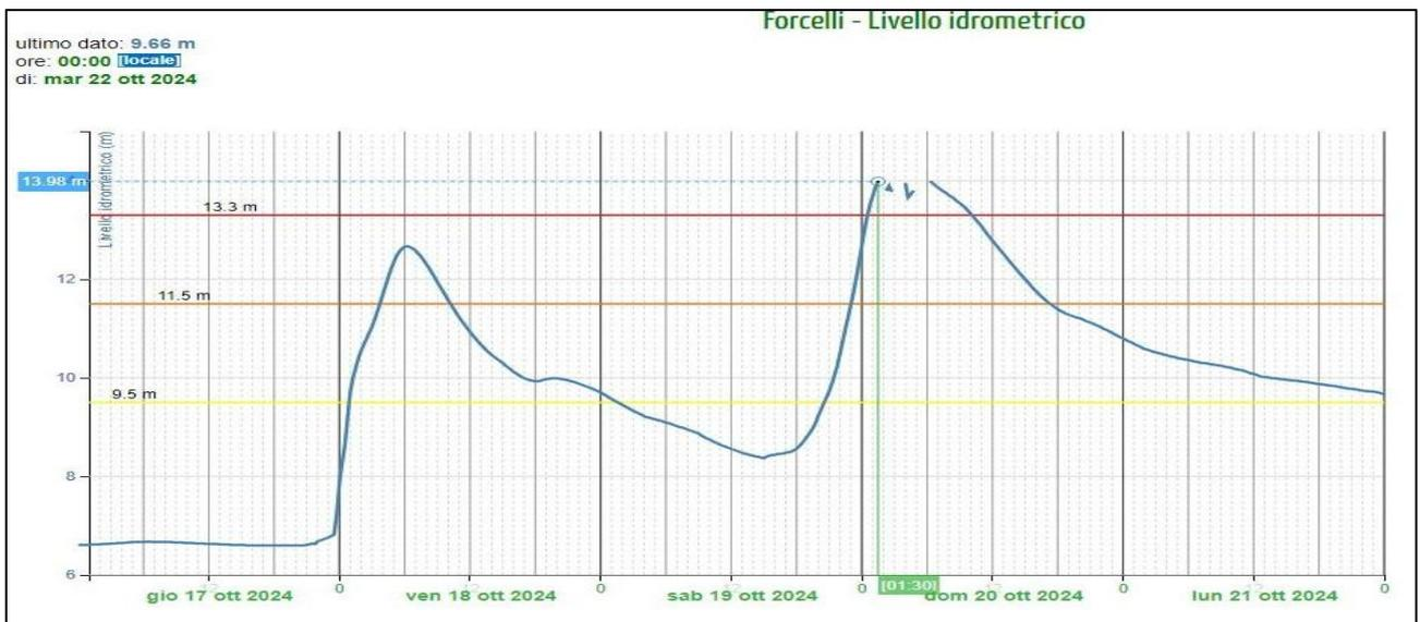
**Figura 9: Idrogrammi di piena nelle sezioni idrometriche più significative del torrente Samoggia e del suo affluente Lavino (dati non validati).**
