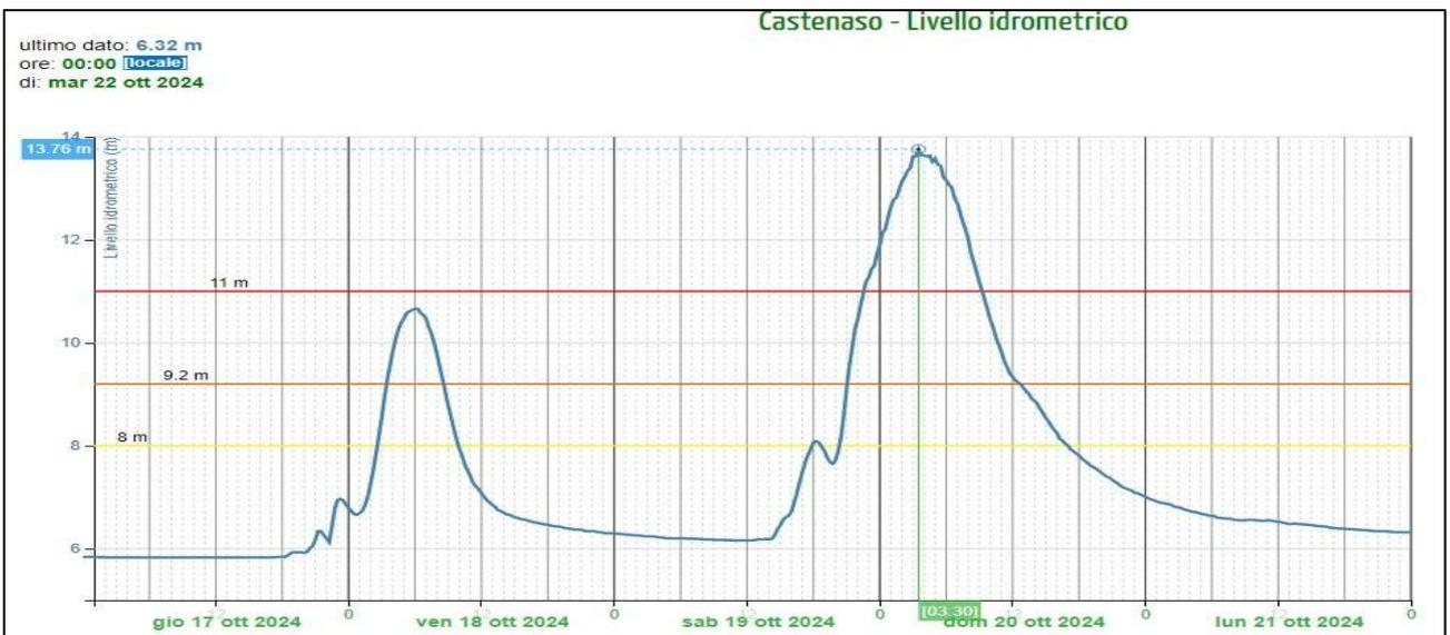
**Figura 11: Idrogrammi di piena nelle sezioni idrometriche più significative del torrente Idice e del suo affluente Savena (dati non validati).**
