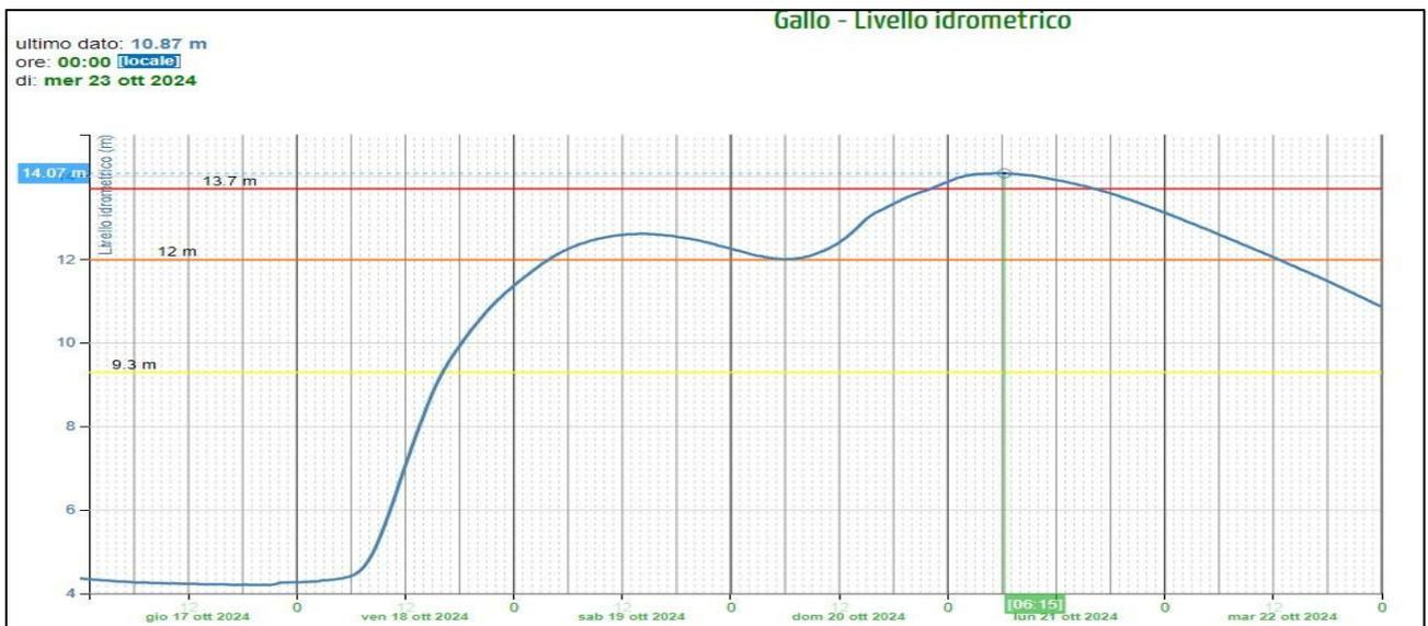
**Figura 10: Idrogrammi di piena nelle sezioni idrometriche più significative del fiume Reno (dati non validati).**
