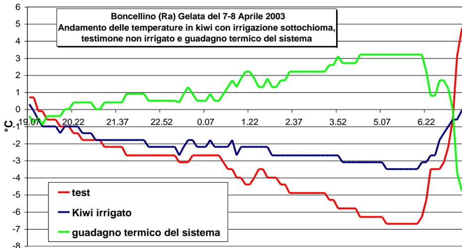
Fig. 3: andamento delle temperature registrate a 1 metro di altezza da terra durante una notte di gelata presso una delle aziende inserite nel progetto DISGELO, in una zona irrigata a confronto con un'area non protetta.
