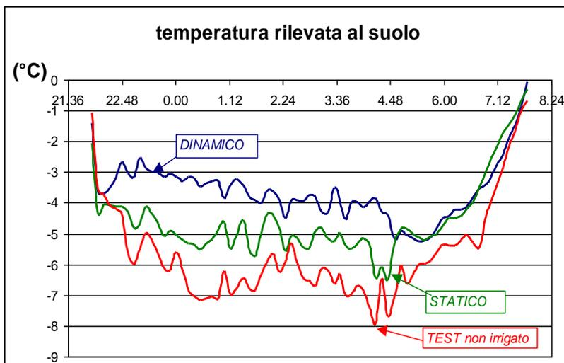
Fig. 2: andamento delle temperature registrate al suolo durante una notte di gelata presso la base meteorologica dell'ARPA-Servizio Meteorologico, di S. Pietro Capofiume (BO). I dati si riferiscono a zone protette con irrigatori statici e dinamici. con la stessa pluviometria oraria. a confronto con un
