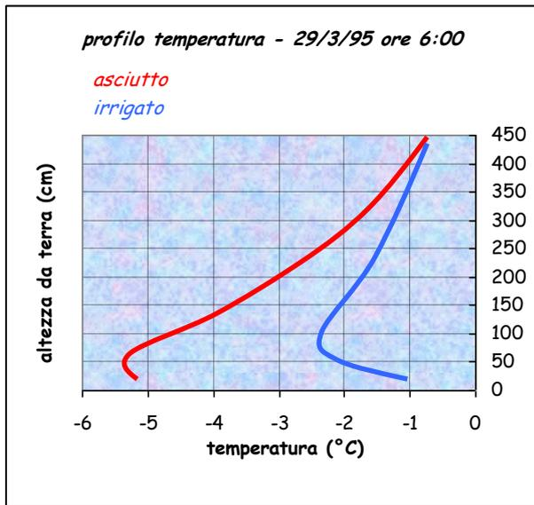
Fig. 1: Variazione del profilo delle temperature per effetto dell'irrigazione antibrina sottochioma, rispetto alla zona non protetta.
