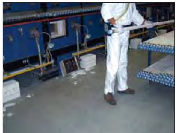
Foto 6 - Sostituzione rulli (valore più elevato)
