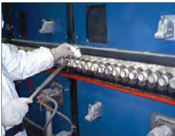
Foto 5 - Tamponamento tra rulli e "passarulli"
