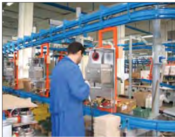
Foto 20 - Fase di montaggio caldaie
