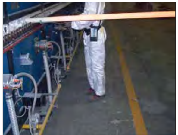
Foto 4 - Estrazione di un rullo dal varco passarulli
