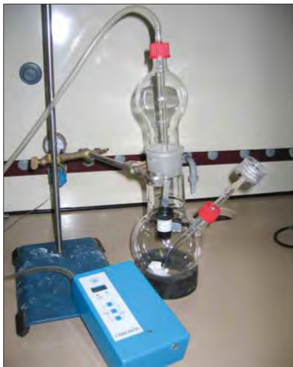
Foto 5 - Apparecchiatura impolveramento filtri
