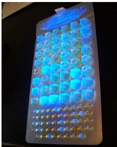
Figura 2.5.1: Colilert dopo incubazione esposto a luce ultravioletta
