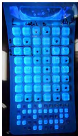
Figura 2.5.2: Enterolert dopo incubazione esposto a luce ultravioletta
