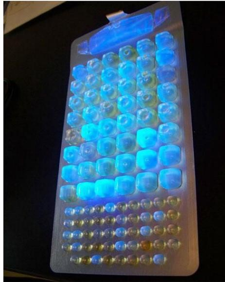
**Figura 3:** Colilert -18®/Quanti-Tray® dopo incubazione esposto a luce ultravioletta
