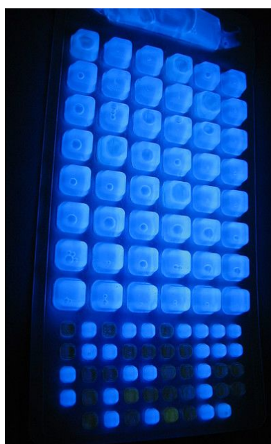
Figura 4: Metodo AFNOR IDX-33-04-02-15 Enterolert®- E dopo incubazione
