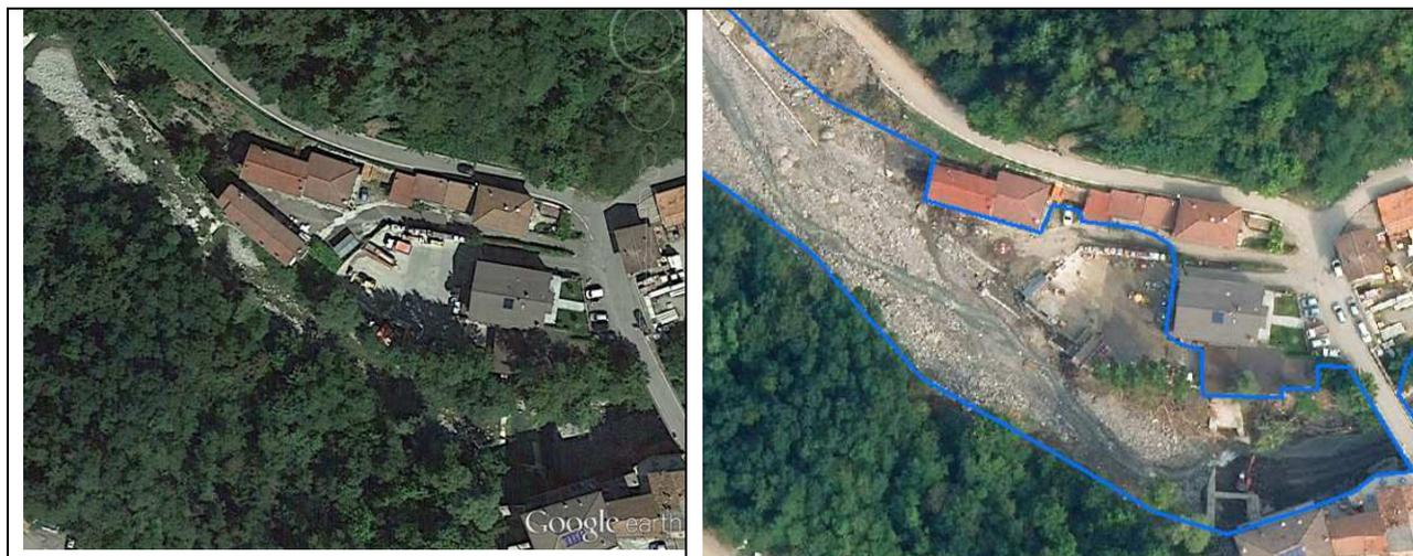
*Figura 31: vista dall'alto del Rio Grondana dentro l'abitato di Ferriere prima dell'alluvione ( a sinistra) e dopo(a destra): dopo l'alluvione si nota la scomparsa di un edificio e la asportazione di una notevole estensione di vegetazione (in blu il limite dell'area allagata).*
