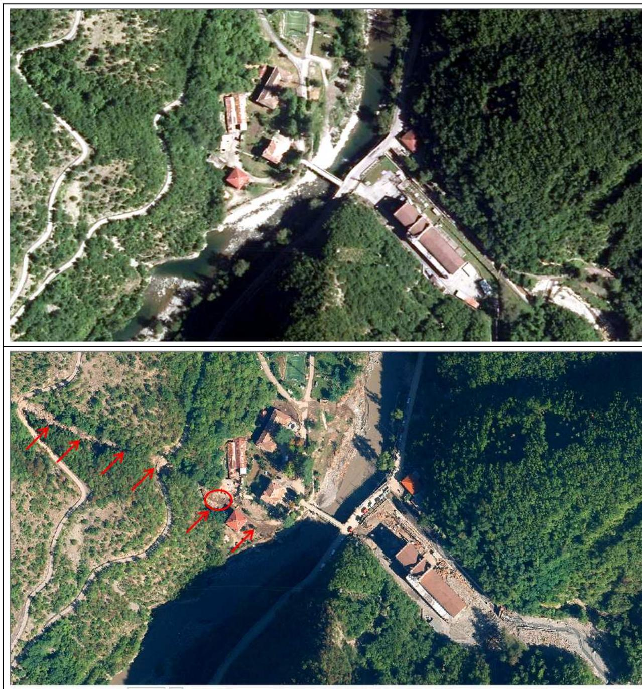
*Figura 19: L'area di confluenza tra il Rio Ruffinati (a destra) e il Torrente Aveto prima dell'evento (in alto) e dopo l'evento (in basso). Si nota il diffuso sovralluvionamento subito dall'alveo del torrente in prossimità della centrale ENEL ( in basso a Destra). In alto sinistra è visibile la traccia di una colata detritica che ha distrutto due tratti della strada per la località Lisore e un manufatto (cerchio rosso) sfiorando un edificio abitato, prima di riversarsi nel torrente Aveto.*
