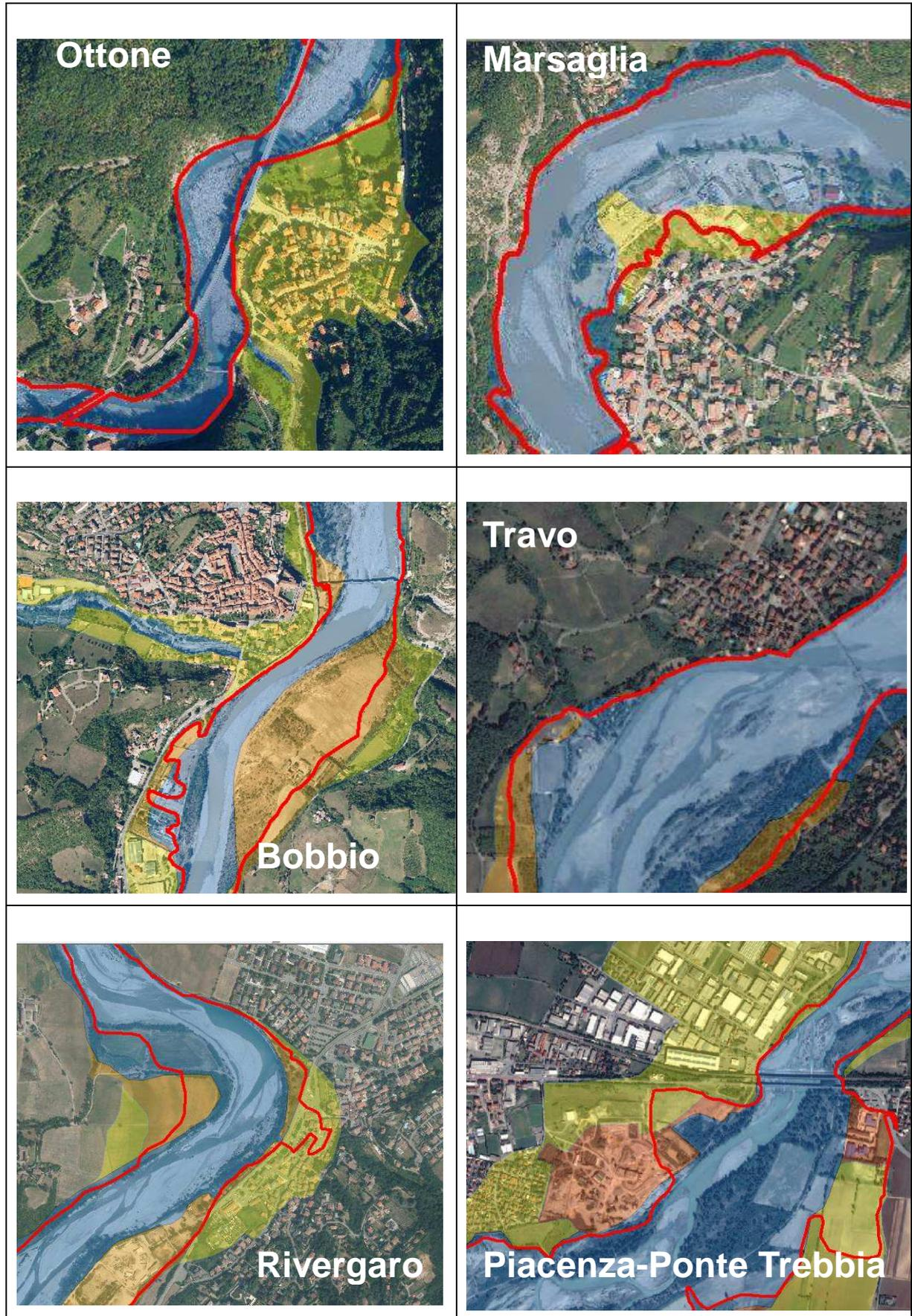
*Figura 43: Aree allagate in alcuni tratti del torrente Trebbia, a confronto con le mappe della Dir 2007/60/CE.*
