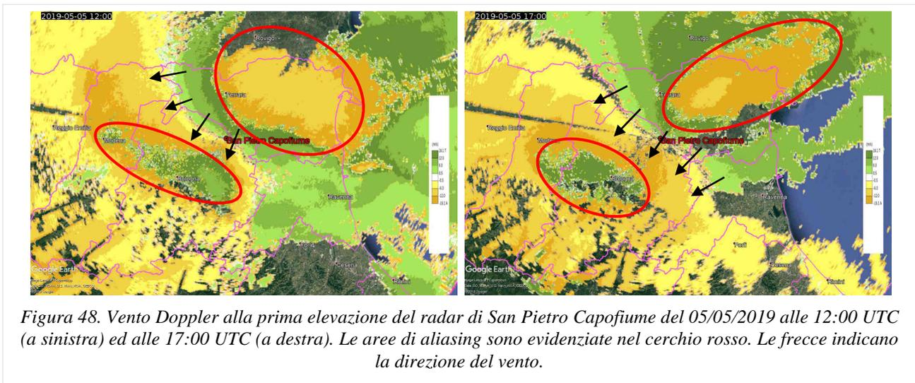
Figura 48. Vento Doppler alla prima elevazione del radar di San Pietro Capofiume del 05/05/2019 alle 12:00 UTC (a sinistra) ed alle 17:00 UTC (a destra). Le aree di aliasing sono evidenziate nel cerchio rosso. Le frecce indicano la direzione del vento.
