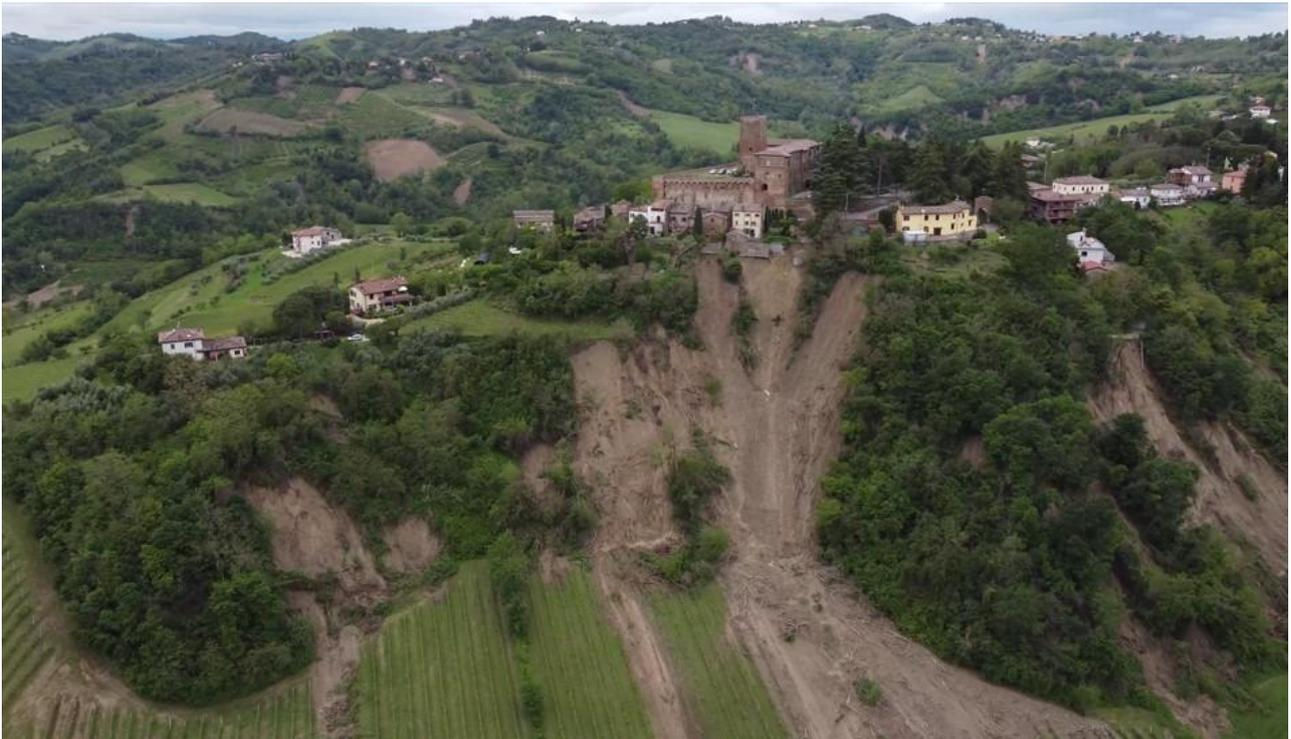
*Figura 61: Esempio della ricorrenza di colate in terra nelle aree più colpite. Sono visibili decine di punti di innesco, tra il versante in primo piano e quelli in secondo piano. Località Sorrivoli in comune di Roncofreddo (FC). Da <https://teleromagna.it/it/cronaca/2023/5/18/sorrivoli-paese-spaccato-in-due-diverse-famiglie-isolate-da-frane-e-acqua-video>*
