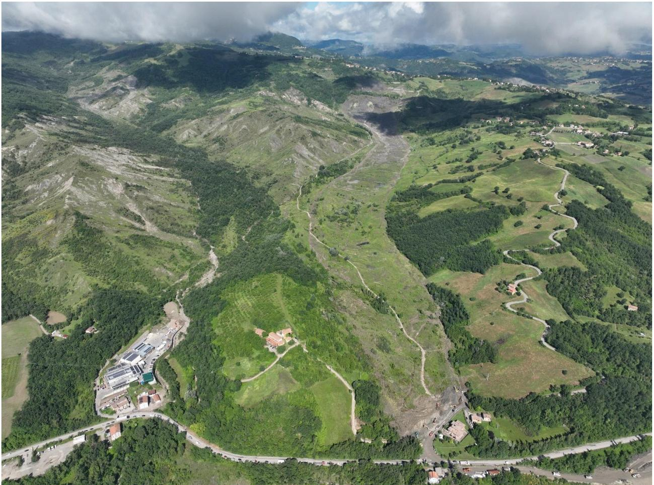
*Figura 64: La frana in argilla di Cà Lita – Poggio del Bue in comune di Baiso (RE). È visibile il fronte di scavo sul quale operano le ruspe al piede della frana, nel tentativo di fronteggiarne l'avanzamento, che ha raggiunto la velocità di 7 m/giorno a inizio giugno, per poi rallentare nelle settimane successive ( foto di Giovanni Bertolini, Agenzia Regionale per la Sicurezza territoriale e Protezione civile).*
