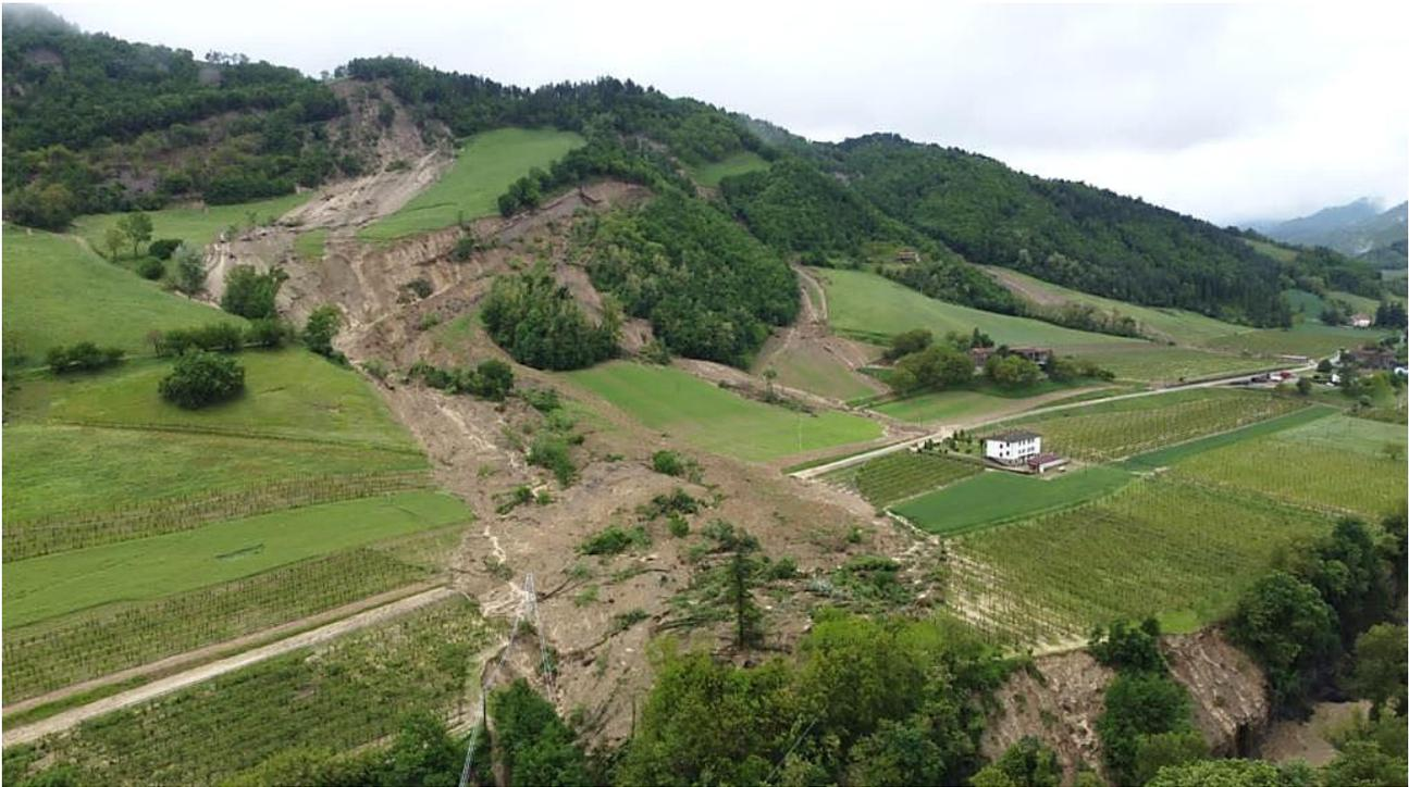
***Figura 63: Frana nei pressi di Baffadi (Casola Valsenio, RA) caratterizzata da tipologie concomitanti di scivolamento in roccia, scivolamento di terra, colata di terra o di detrito.***
