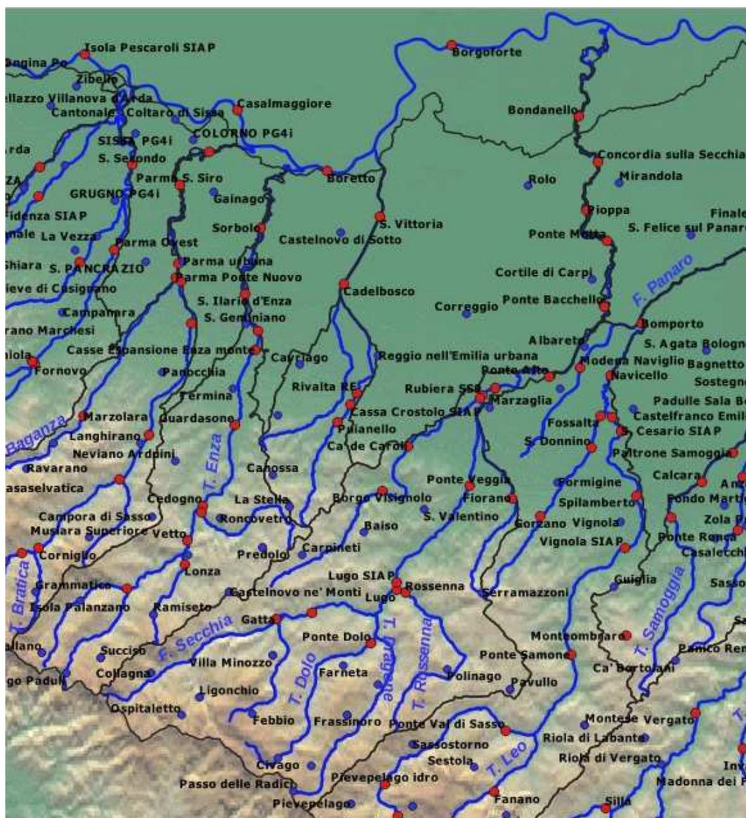
Figura 27: Bacini idrografici dei fiumi Enza e Secchia, con ubicazione delle stazioni di misura idrometriche (in rosso) e pluviometriche (in blu).
