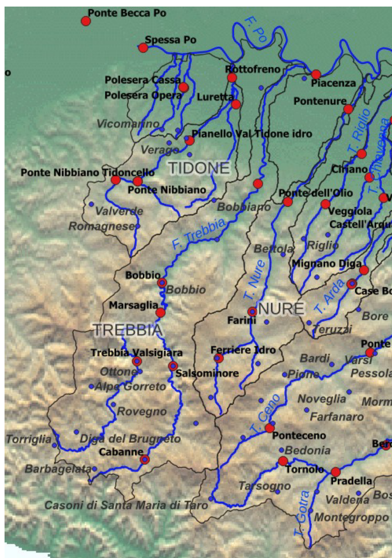
Figura 13: Bacino idrografico del Trebbia, con l'ubicazione delle stazioni pluviometriche (in blu) e idrometriche (in rosso).
