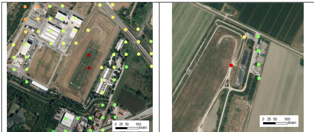
Figura 4.6: Esempi di zone con velocità verticale del suolo anomale dovute ad attività antropiche o infrastrutture riconosciute come outliers.
