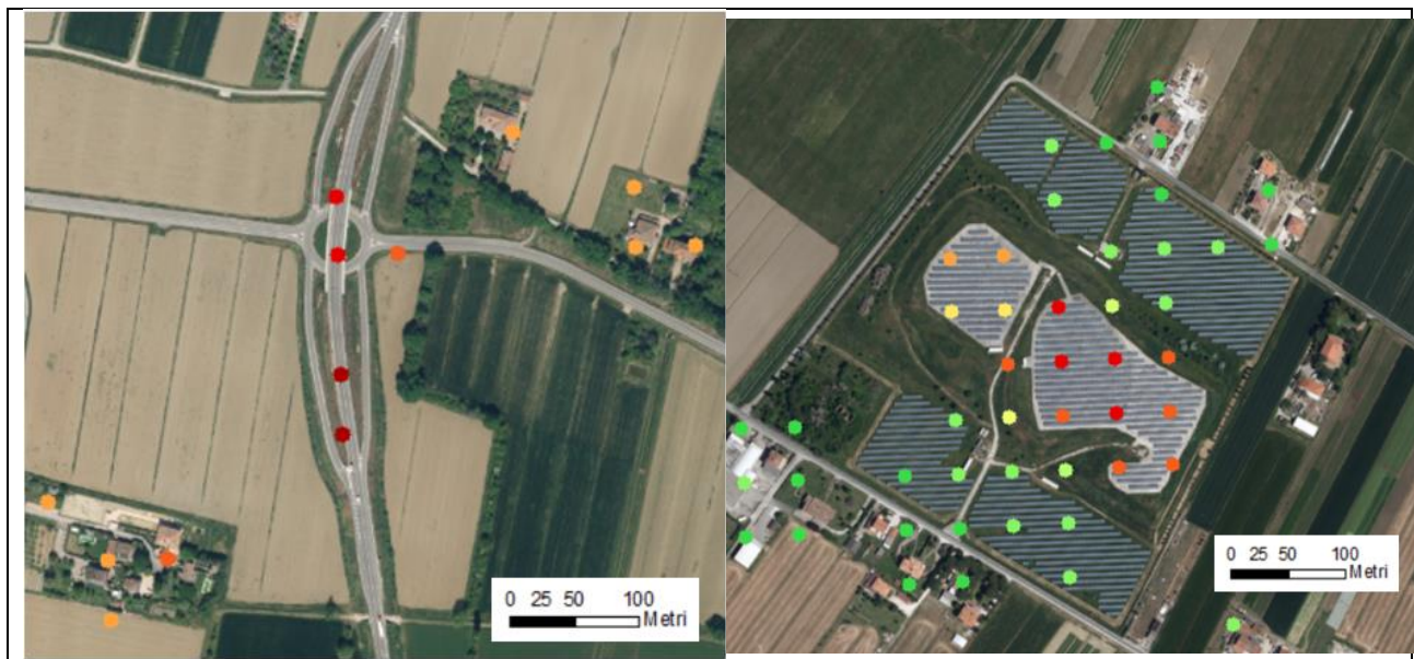
Figura 4.5: Ubicazione degli outliers individuati inizialmente tra gli estremi (minimi e massimi) della distribuzione di frequenza delle velocità verticali medie del periodo per confronto con attività antropiche note sul territorio o evidenziate singolarmente a scala locale.
