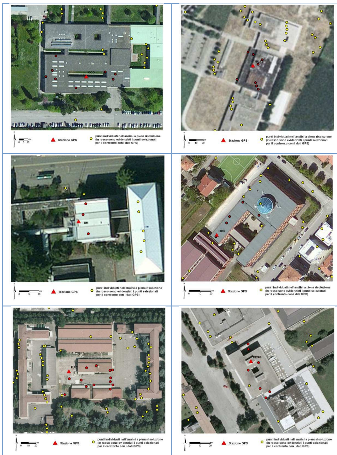
Fig. 14 - Distribuzione dei punti di misura individuati nell'analisi SqueeSAR™ a piena risoluzione nell'intorno delle stazioni GPS; sono evidenziati in rosso i punti di misura selezionati per il confronto con i dati GPS.
