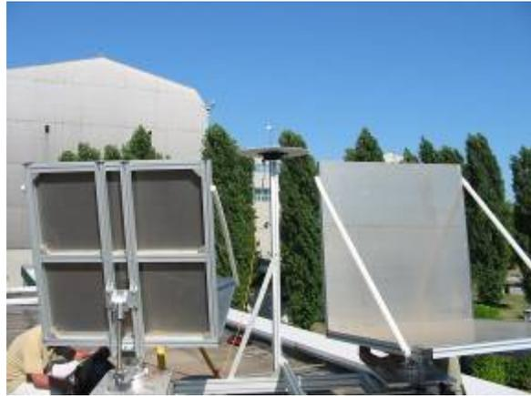
**Fig. 13** - riflettori artificiali di tipo “*corner*” (sopra a sinistra), di tipo “*planar*” o specchio piano (sopra a destra), e di tipo diedro (sotto).
